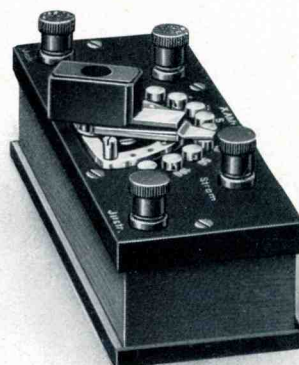
Größe: 180×60×70 mm Kurbelnebenschuß zum Vakuumthermoelement
