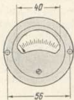
Form LE, Einbauminstrument.
