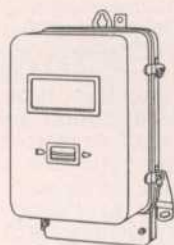
Kontaktgeber in D7-Gehäuse (306 × 170 × 147 mm).
