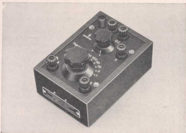
Nebenwiderstand für Isolations- und Ladungsmessungen Listen-Nr. 157032.
