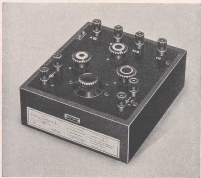
Eicheinrichtung für Galvanometer Listen-Nr. 157095.
