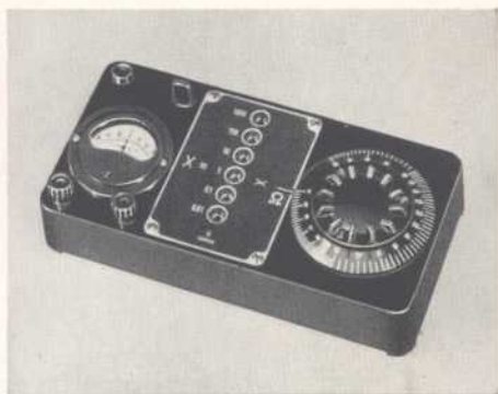
Meßbrücke Form Z in Wheatstoneschaltung für Messungen mit Gleichstrom.
