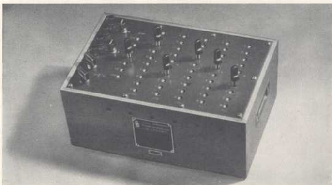
Kleine Stöpselmeßbrücke mit Vergleichswiderstand in Reihenschaltung.
