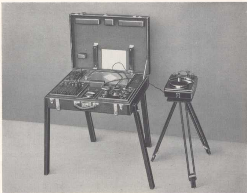
Kabelmeßschaltung mit Zeigergalvanometer gebrauchsfertig aufgestellt.
