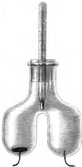
Dies Gefäss wird in verschiedener Weise gefüllt, je nachdem das Element am Orte der Herstellung benutzt werden oder zur Versendung gelangen soll.
